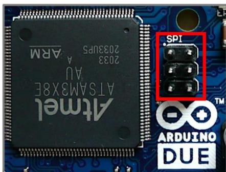
Abbildung 1 Die SPI-Schnittstelle
