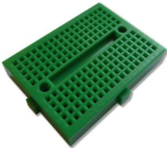
Abbildung 5: Das Mini-Breadboard
