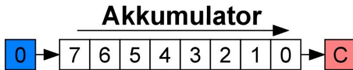
Abbildung 181 - Der LSR-Befehl (Auswirkung auf den Akkumulator)
