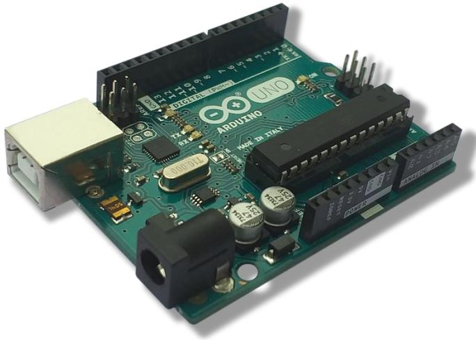
Abbildung 2 Das Arduino-Uno-Board
